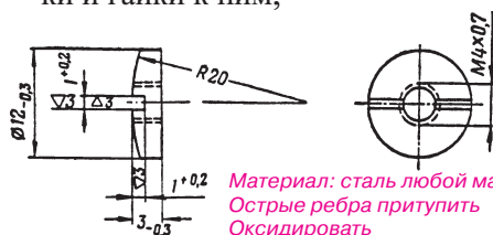
Гайка шпильки шейки ложки
