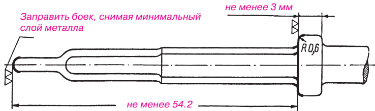
Опиловка передней поверхности венчика ударника и заправка бойка
