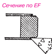
Подготовка магазинной коробки для приварки щек
