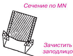
Обработка магазинной коробки после приварки щек
