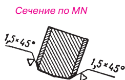
Подготовка магазинной коробки для приварки щек
