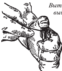
Удерживание курка при спуске его с боевого взвода
